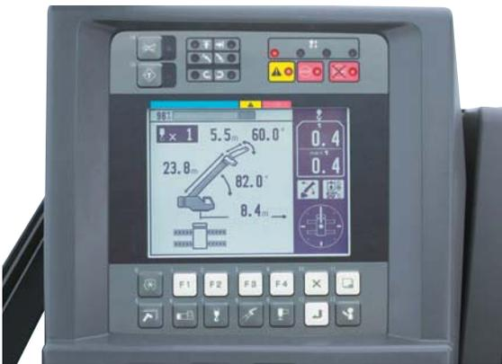
起伏角度、ブーム長、作業半径、アウトリガ張出幅等の作業状況を1つの画面に液晶表示。安全な作業を見守ります。
